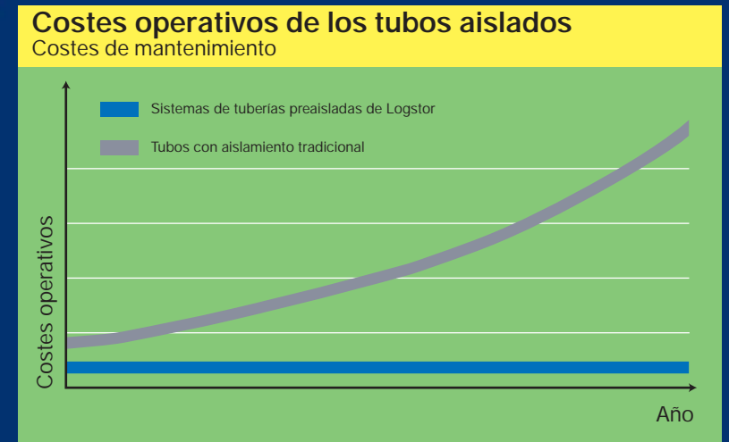
Fig. 6 Los costes operativos se mantienen a un nivel constante y reducido en los tubos de Logstor.
