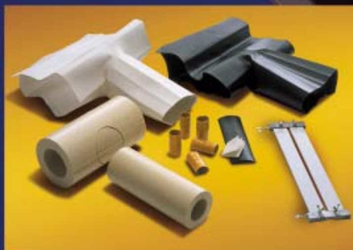
Fig. 12 Conjunto de junta en T Con semiconchas de PUR, manguitos ajustados y accesorios. Negro o blanco. Dimensiones del tubo principal de 90 a 200 mm. Dimensiones del tubo de empalme de 66 a 180 mm. Tubos de empalme en ángulo disponibles. (Requiere herramienta de conexión).
